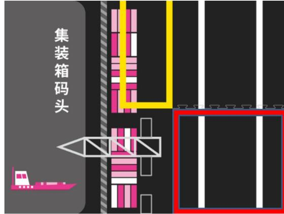
智能车将集装箱成功投放入集装箱放置区范围中且投放后集装箱垂直投影不超过集装箱放置区范围，集装箱放置区范围如下图红色标记框范围所示，视为完成集装箱投放。集装箱放置区范围尺寸为 20cm\*44cm。如果因后续放置的集装箱导致先前放置的集装箱脱离放置区，则先前放置的集装箱不得分。
