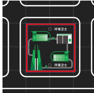
智能车将垃圾桶成功投放入垃圾回收站范围中且投放后垃圾桶垂直投影不超过垃圾回收站范围，垃圾回收站范围如下图红色标记框范围所示，视为完成垃圾桶投放。垃圾回收站范围尺寸为20cm\*44cm。垃圾回收站分为“有害垃圾”和“可回收垃圾”两个区域，每个区域占总区域的一半，尺寸为20cm\*22cm。将蓝色“可回收垃圾桶”投放入“可回收物”区域以及将红色“有害垃圾桶”投放入“有害垃圾”区域，则视为正确投放入垃圾回收站中。如果因后续投放的垃圾桶导致先去投放的垃圾桶脱离垃圾回收站，则先去投放的垃圾桶不得分。
